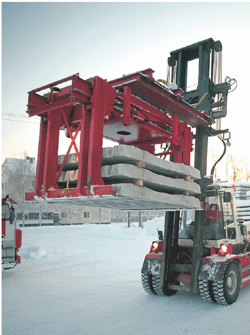
Tarrain betonisille ratapölkyille trukilla nostettaessa
