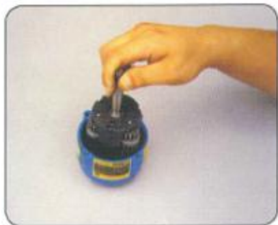
16. Irroita akselin vastakappale vaihteistosta
