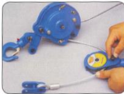
10. Pujota taittopyörällinen koukku paikalleen
