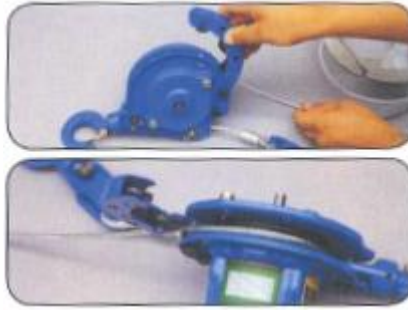
7. Nosta painintela mekanismi ja vedä vaijeri paikalleen
