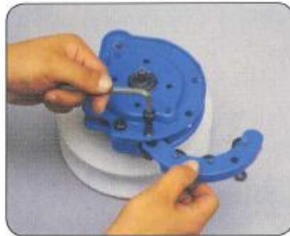
5. Irroita kuormapyörän kotelo
