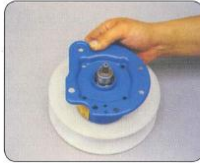
14. Nyt runko on irroitettu vaihteiston kotelosta, nosta se pois
