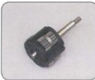
17. Vaihteisto on irroitettu vinssistä
