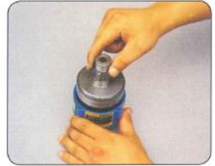
15. Irroita akseli vaihteistosta
