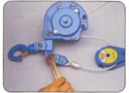
11. Kiinnitä vaijeri ripustusosaan
